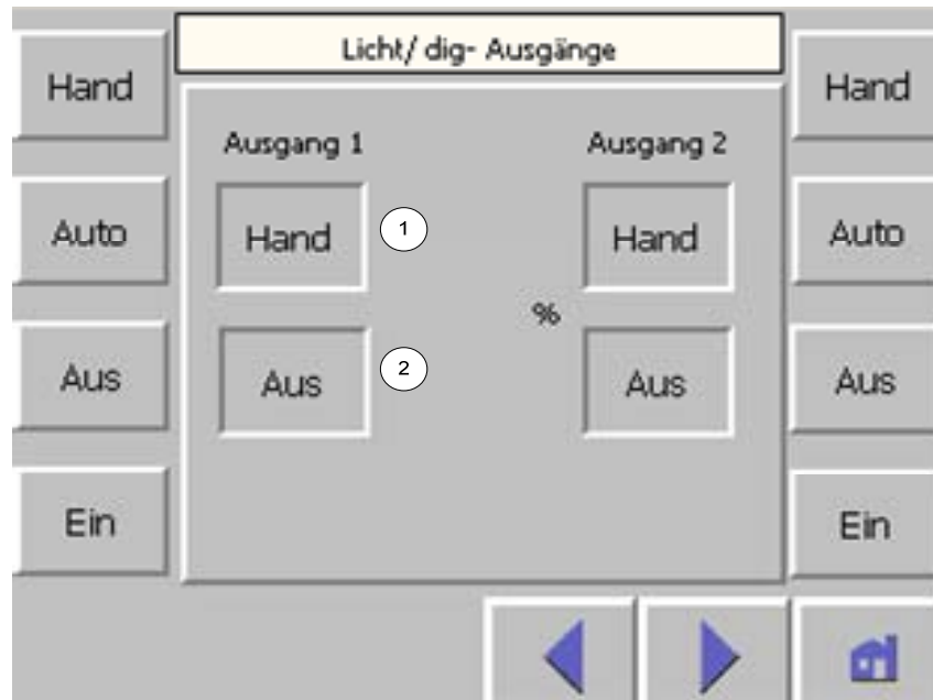
Abb 13- Bedienung dig. Ausgänge
